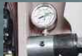
▶ Bandspannungs-Anzeige Zur Kontrolle der optimalen Sägebandspannung auch während des Betriebes der Maschine (Option)
