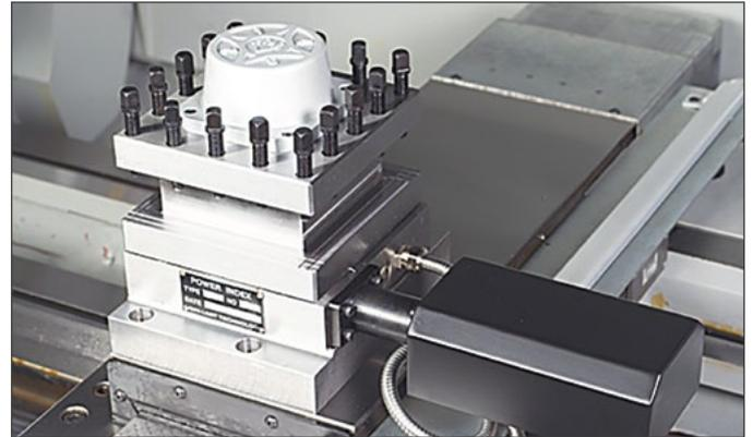
Mit einem automatischen Werkzeugwechsler mit bis zu 4 Werkzeugen lassen sich Werkstücke ohne Programmunterbrechung automatisch in einer Aufspannung fertigen. Werkzeug-Querschnitt 20 mm x 20 mm.
