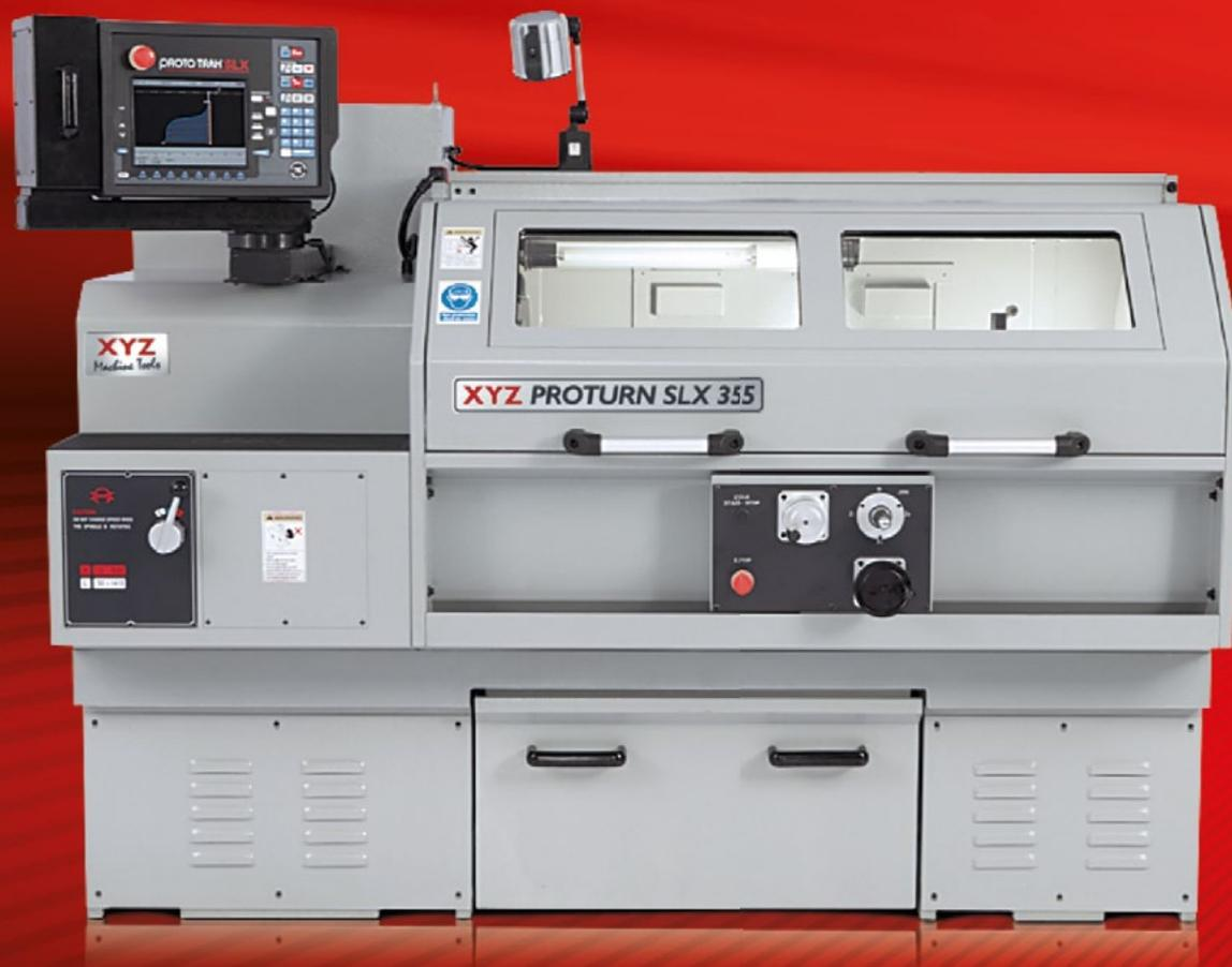
**D**ie XYZ ProTURN Drehmaschinen sind aus einem Teil basierend auf einem stark verrippten Monoblock-Gussbett gefertigt. Diese stabile und massive Gusskonstruktion verleiht der Maschine eine hohe Eigensteifigkeit, ein extrem hohes Gewicht und damit gute Standfestigkeit. Das im Spindelkopf integrierte Getriebe aus präzisionsgeschliffenen Wellen und Zahnrädern höchster Qualität realisiert ruhigen Lauf.
