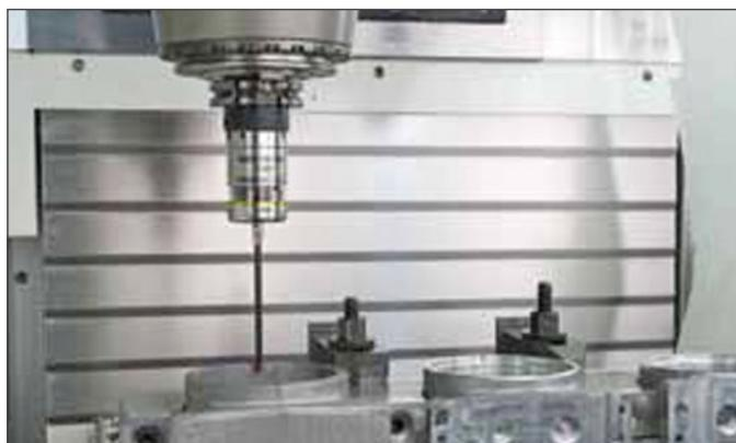
Sparen Sie wertvolle Bearbeitungszeiten indem Sie direkt in der Maschine mit einem RENISHAW OMP400 Messtaster das Werkstück vermessen und die Messwerte direkt verarbeiten.
