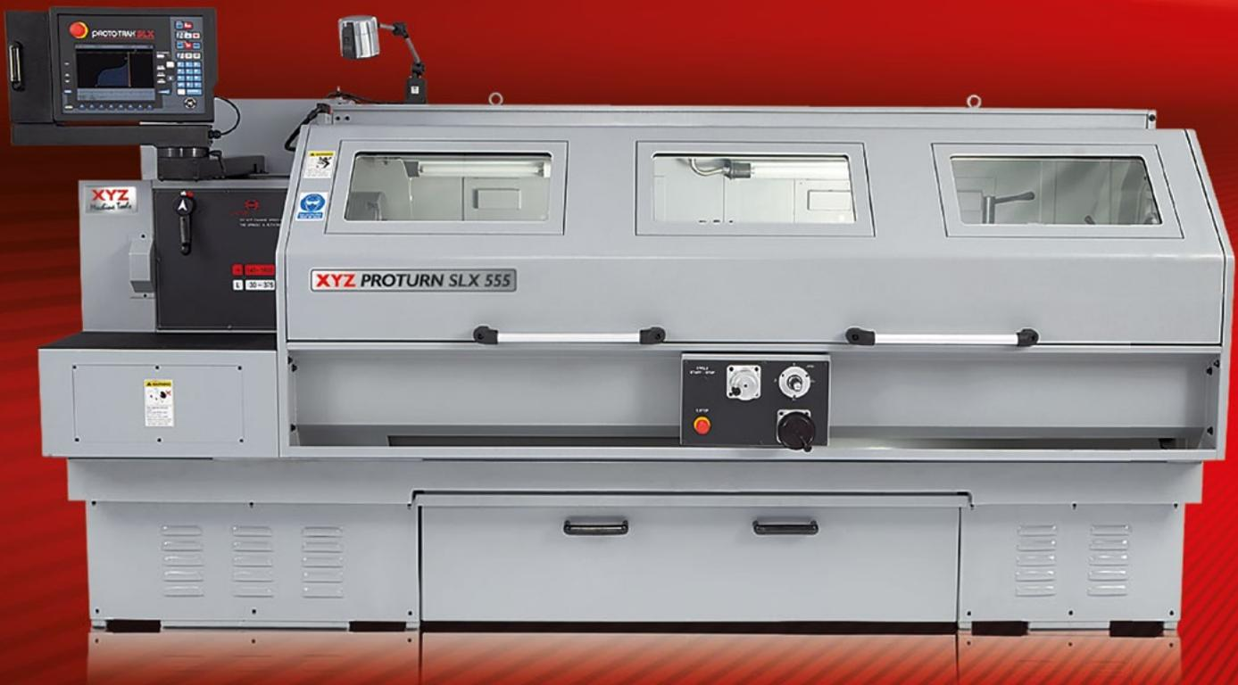
**D**ie XYZ ProTURN Drehmaschine ist aus einem Teil basierend auf einem stark verrippten Monoblock-Gussbett gefertigt. Diese stabile und massive Gusskonstruktion verleiht der Maschine eine hohe Eigensteifigkeit, ein extrem hohes Gewicht und damit gute Standfestigkeit. Das im Spindelkopf integrierte Getriebe aus präzisionsgeschliffenen Wellen und Zahnrädern höchster Qualität realisiert einen ruhigen Lauf.
