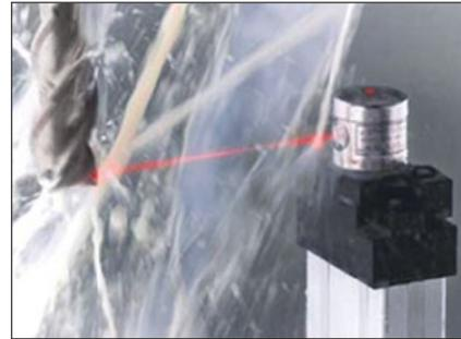
Kontaktlose Werkzeugbrucherkennung. In Verbindung mit der Möglichkeit, ein Schwesterwerkzeug in der SIEMENS SINUMERIK 828D zu definieren, können sie beim Erreichen der Verschleißmarke automatisch mit dem Schwesterwerkzeug weiterarbeiten.
