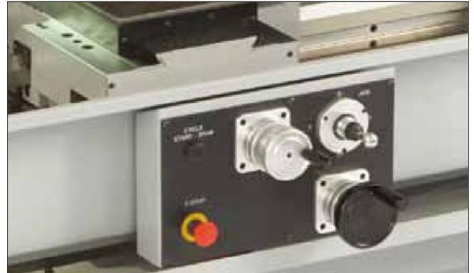
Der Bearbeitungsraum lässt sich komplett öffnen und das im Standardlieferungsumfang enthaltene TRAKing® (elektrische Handräder) erleichtert Ihnen die anstehenden Bearbeitungsaufgaben.
