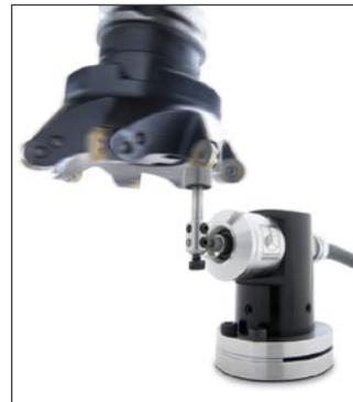
Optional kann die Mini Mill 560 zum Beispiel mit einem berührenden Messtaster zur Werkzeugmessung und -bruchkontrolle ausgerüstet werden.
