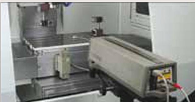
Laservermessung auf einem VMC 710 CNC Bearbeitungszentrum.
