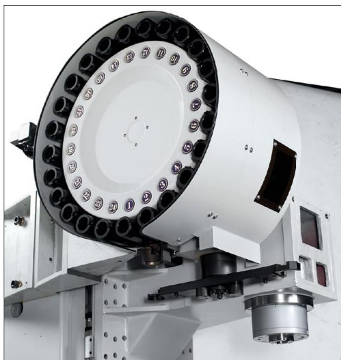
Im Magazin stehen 24 Werkzeuge zur Verfügung, die innerhalb 2,5 Sek. mit einem Wechslerarm mit Doppelgreifer eingewechselt werden.
