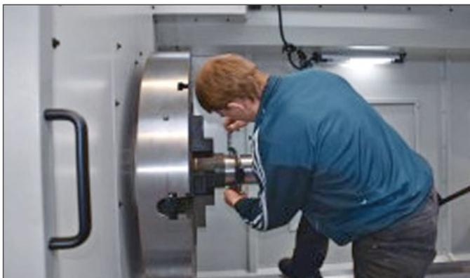
Beleg für höchste Genauigkeit: Auf 700 mm Länge, fliegend gedreht, werden Genauigkeiten von 0,009 mm eingehalten.
