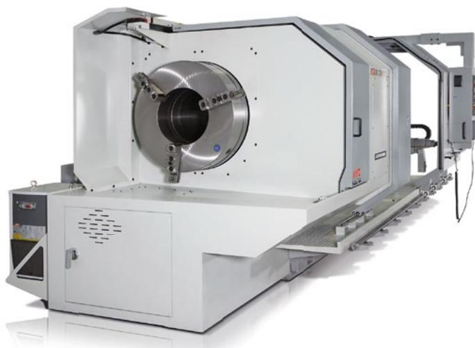
Hinteres Dreibackenfutter zur schwingungsfreien Bearbeitung der Rohre.
