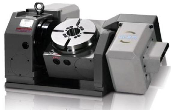
Die 2-Achsen CNC-Dreh-/Schwenktische erweitern die VMC 1020 um weitere 2 Achsen. Die beiden Achsen interpolieren mit den bestehenden 3 Achsen Ihres Bearbeitungszentrums, dadurch haben Sie eine 5-Achsen-Maschine, mit der Freiformflächen hergestellt werden können.
