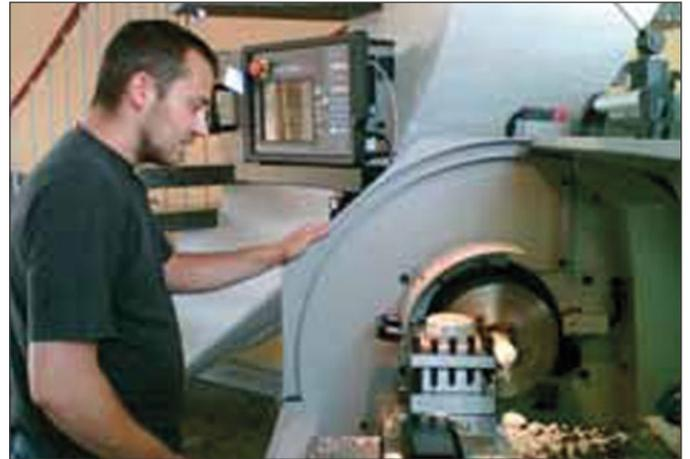
Alle Zyklendrehmaschinen lassen sich im manuellen Betrieb bei geöffneter Bedientür wie eine manuelle Drehmaschine, nur komfortabler, bedienen. Die Sicherheit wird durch ein zweifaches Sicherheitskonzept erreicht – einmal über einen elektrisch verriegelten Futterschutz und zum anderen über eine Programmabfrage der Bedientür über Endschalter im Automatikbetrieb
