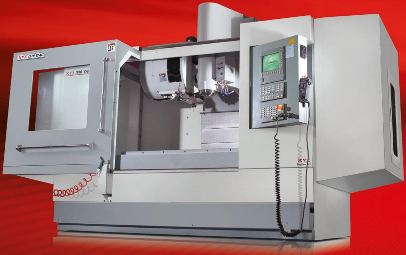
**Das Raumwunder in Ihrer Fertigung, mit 1500 mm Verfahrenweg in der X-Achse und einer Aufspannfläche von 1600 x 600 mm.**
